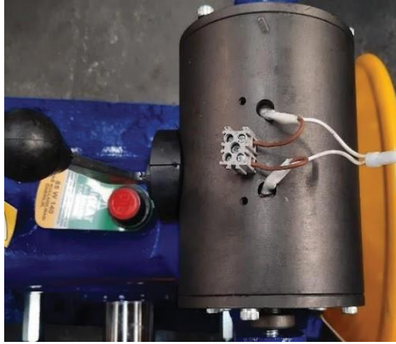
Şekil 7.2. 198 v DC Fren Bağlantısı
