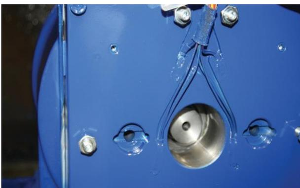
6. Прикрепите энкодер на место на корпусе машины, выполнив действия в обратном порядке.
