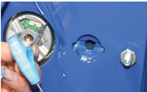
4. Ослабьте болт Imbus на фиксирующем кольце корпуса энкодера с помощью соответствующего шестигранного ключа.
