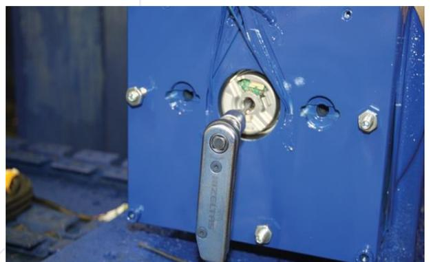
3. Снимите имбусный болт энкодера с помощью соответствующего шестигранного ключа.
