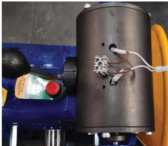
Şekil 9.2 198 VDC fren bağlantısı
