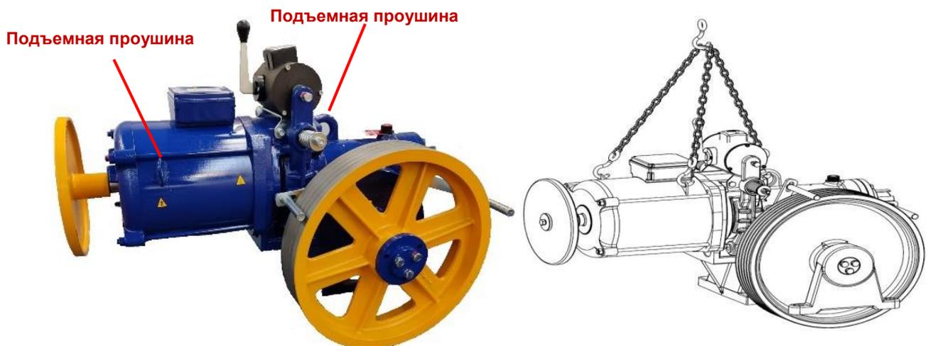
Рисунок 1. Положение машин типа ZF при транспортировке
